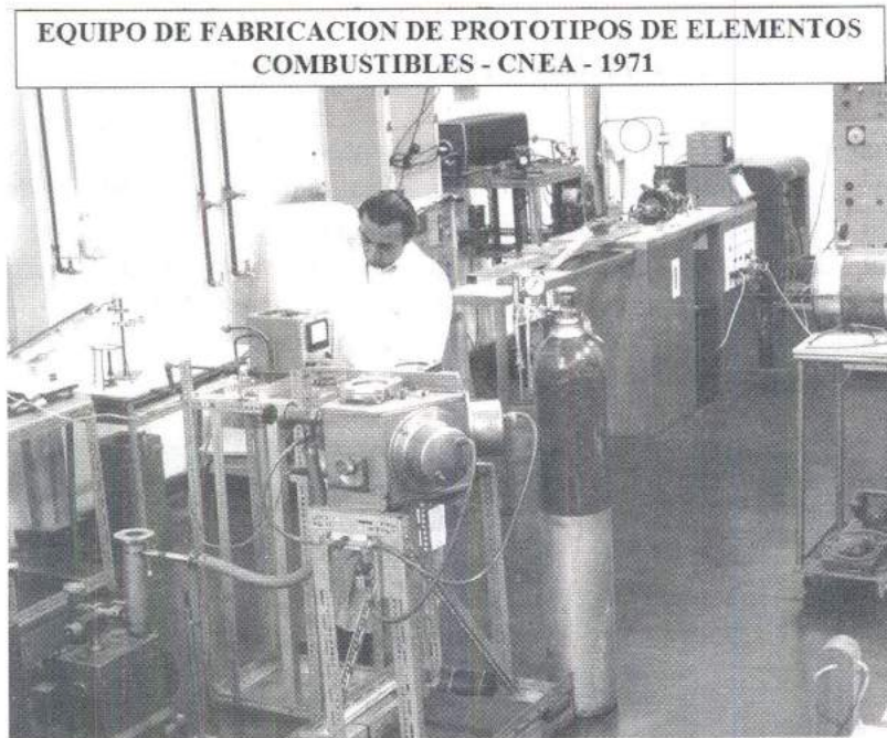
Figura 66.- Planta piloto de elementos combustibles de potencia.
