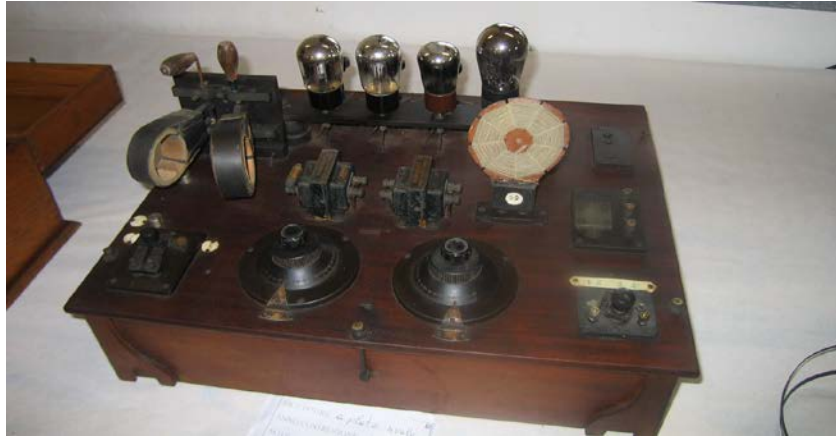
Radio de origen francés, con cuatro válvulas y auriculares, de 1919.
