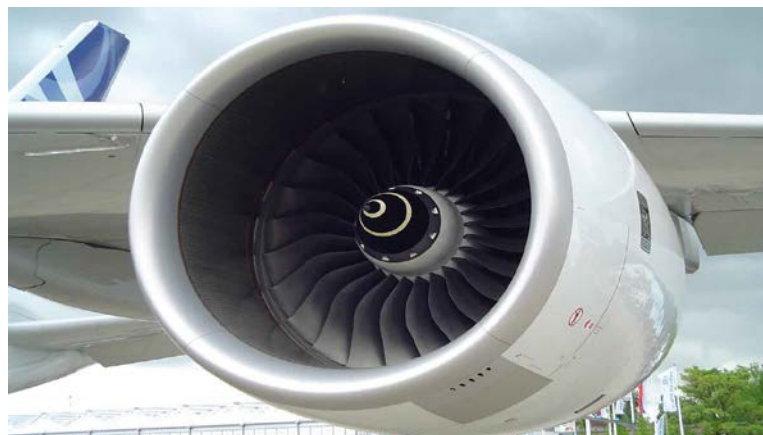
Las turbinas del Airbus A380 usan alrededor de 11 toneladas de titanio.
